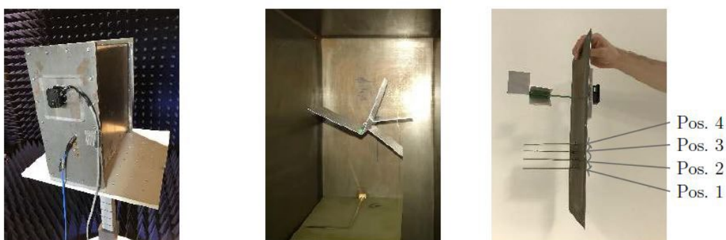
Figure 3.B.17 : maquette et brasseur (gauche : commande du moteur d'entraînement du brasseur / centre : brasseur / droite : empilement de quatre cartes)
