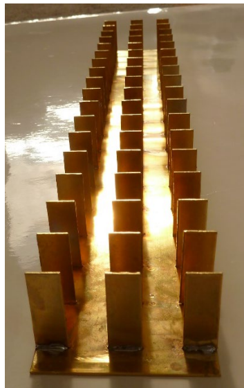
Figure 3.A.41 : maquette de métamatériau – fréquence 1 GHz
