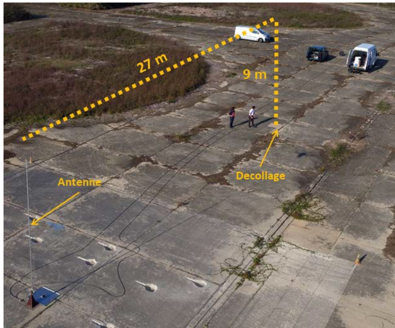
Figure 3.A.46 : trajectoire du drone pour la caractérisation en champ proche du monopôle en situation (en bas, à gauche) [HER-2021]
