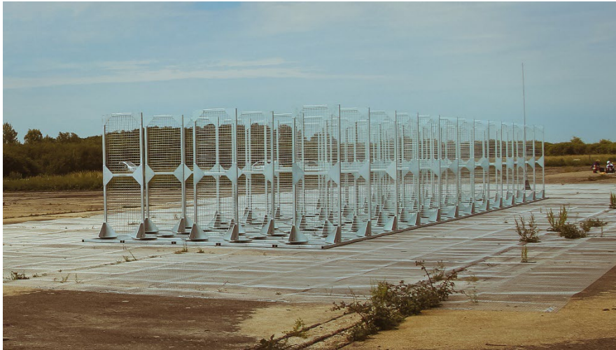
Figure 3.A.50 : antenne HF à métamatériau : monopôle et structure périodique [HER-2021]
