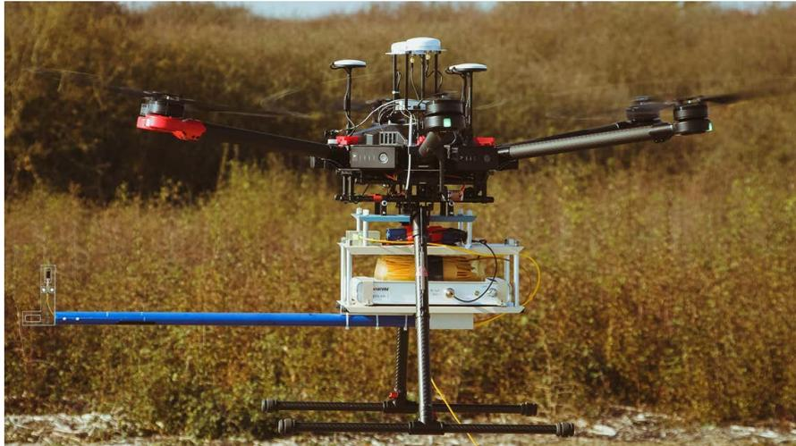
Figure 3.A.45 : drone équipé du système de mesure [HER-2021]
