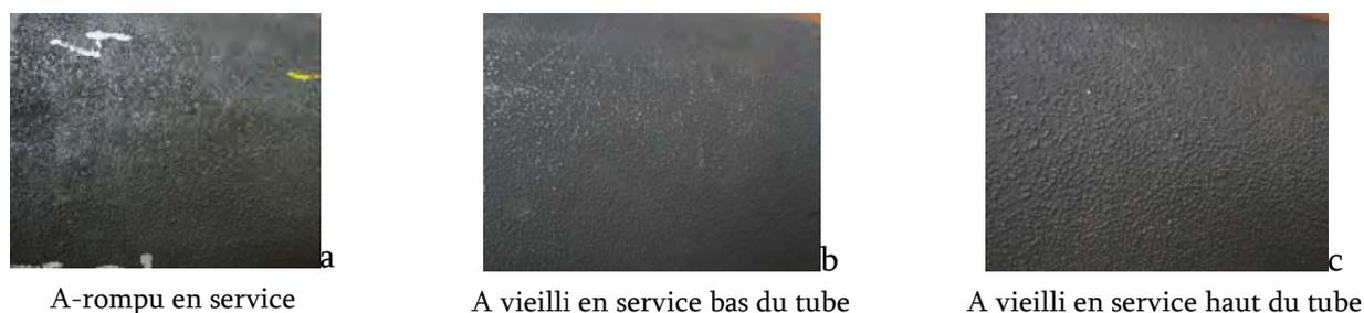
**Figure II- 15 :** *Surfaces externes des tubes a) rompu en service ; b) vieilli sur site -bas du tube ; c) vieilli sur site - haut du tube*
