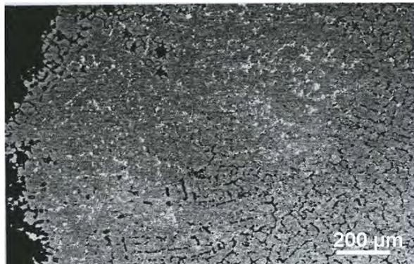
**Figure I- 35 :** Zone appauvrie en chrome en surface interne d'un tube HP45Nb rompu en service [12]
