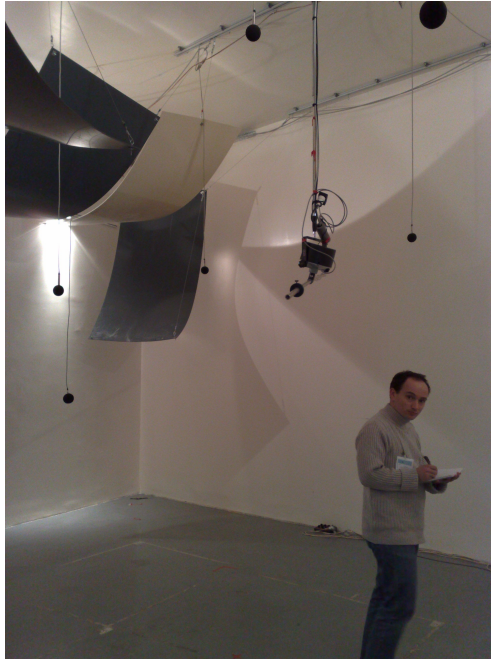
FIGURE 2.3 – Chambre réverbérante acoustique du LNE (Trappes). Les plaques suspendues sont des diffuseurs servant à casser tout degré de symétrie afin d'assurer une chaoticité du milieu ; les microphones suspendus servent quant à eux à échantillonner le champ. Au centre une tige rotative qui sert à échantillonner le champ ; le mouvement de cette tige a un effet de brassage du champ.
