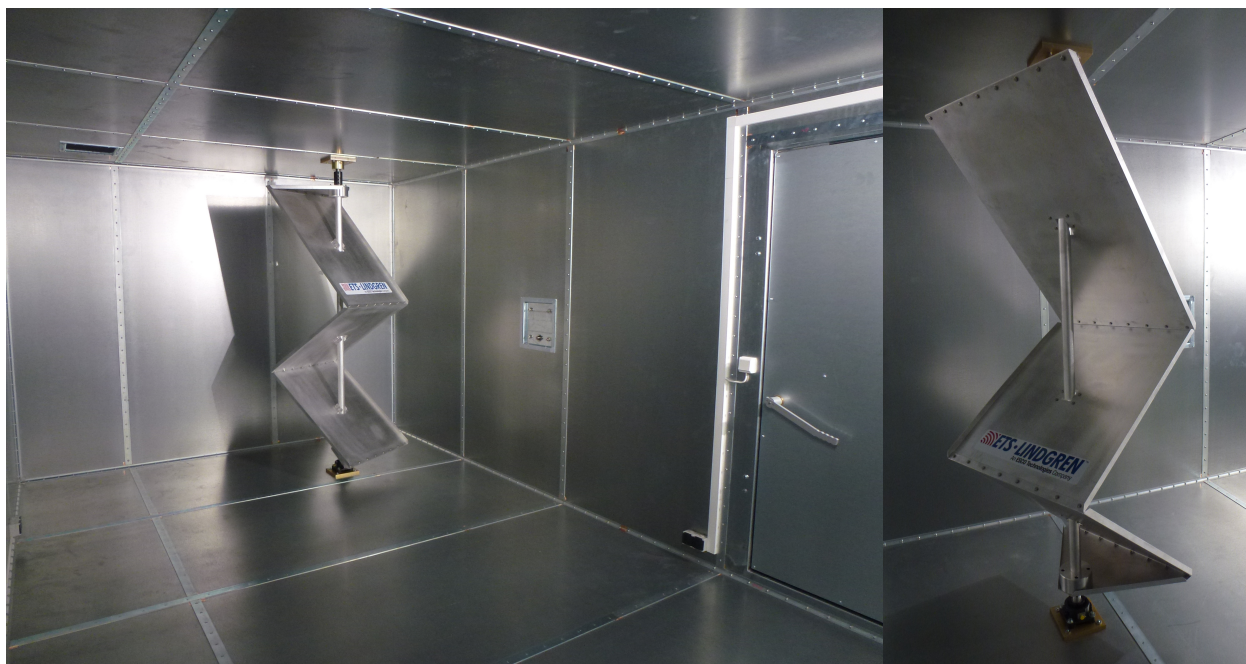
FIGURE 2.1 – Chambre réverbérante à brassage de modes de CentraleSupélec. Le pale en mouvement modifie les conditions limites et permet de « brasser le champ » au sein de l'enceinte.
