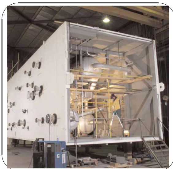
FIG. 1.14 – Boite froide d'un échangeur FIVES CRYO
