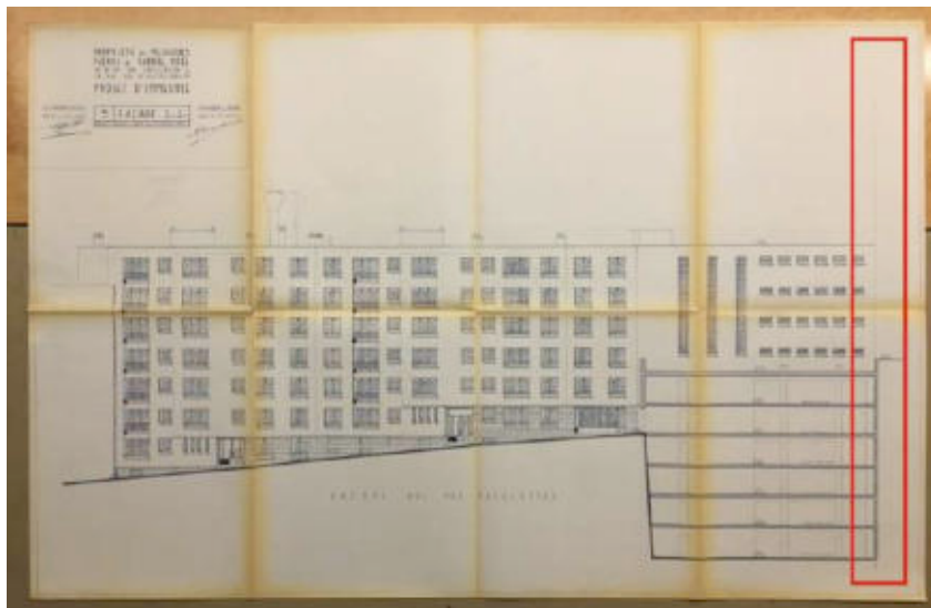
III. 304 Immeuble construit le long de la rue des Reculettes, aux numéros 14,16 et 18. Façade côté rue des Reculettes qui venant l'avenue de la Sœur Rosalie descend avec une forte déclivité vers la rue Croulebarbe. La mitoyenneté avec la tour se trouve à droite [encadré en rouge]. Archives de la ville de Paris, 1069W_472.
