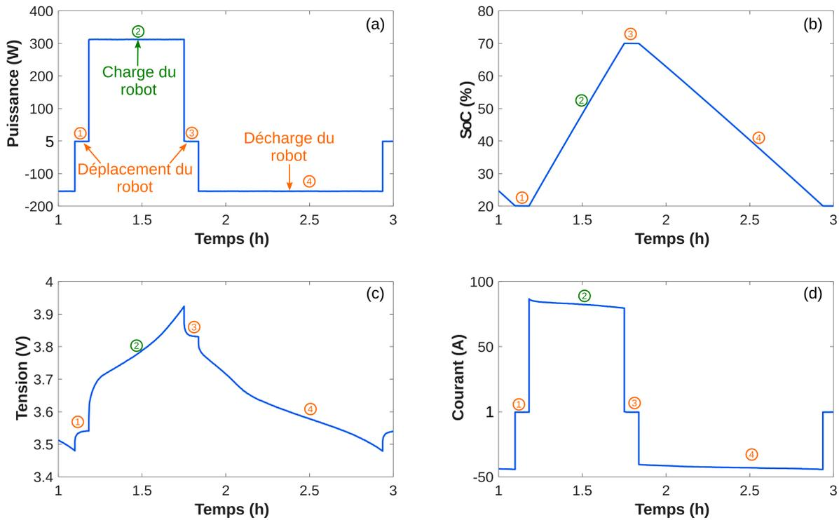
FIGURE 3.6 – Évolution de la puissance (a), de l'état de charge (b), de la tension (c) et du courant (d) d'une cellule utilisé dans une station de recharge mobile.
