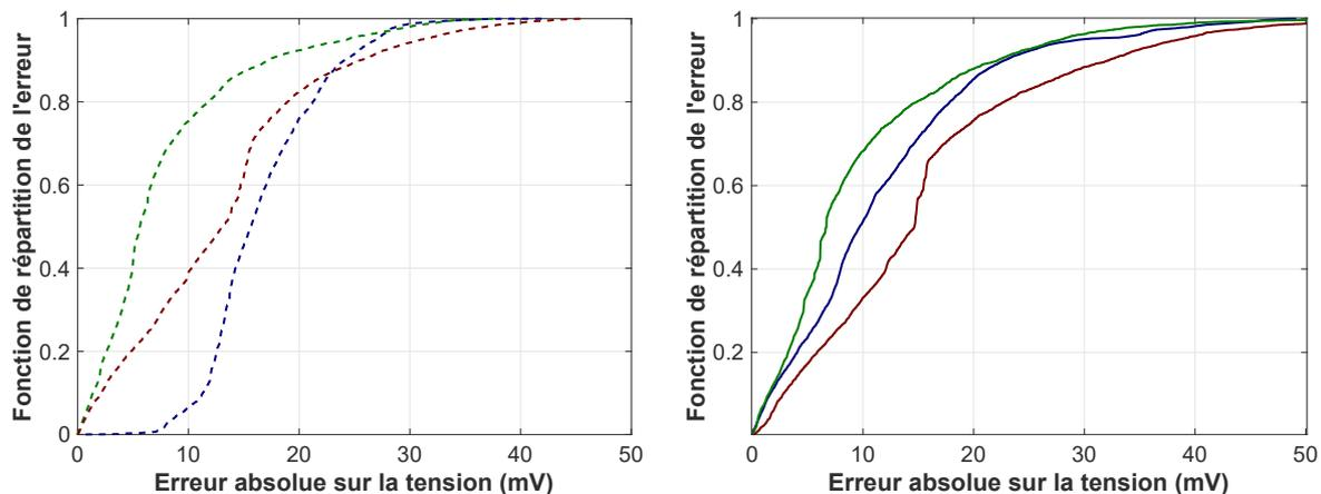
FIGURE 5.10 – Influence de la température sur la précision des modèles RC (à gauche, en ligne pointillée) et CPE (à droite, en ligne continue). Les courbes bleues, vertes et rouges présentent respectivement la précision à 0, 25 et 40 °C.
