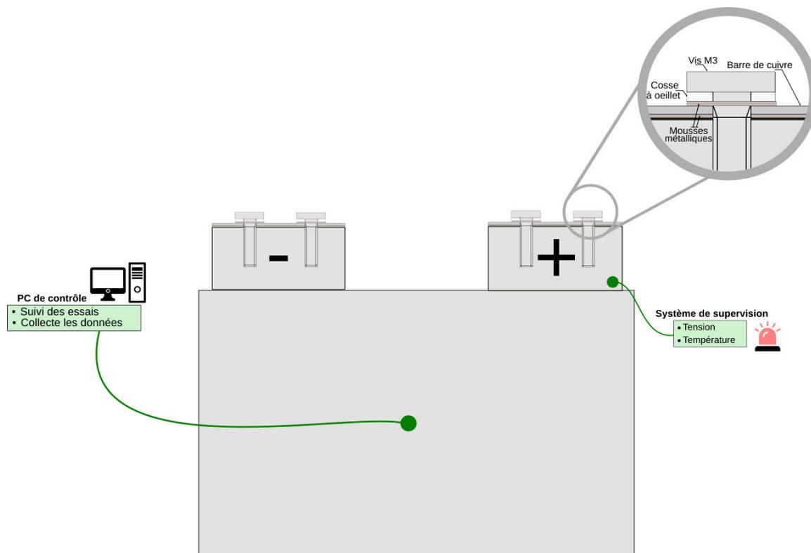
FIGURE 3.12 – Montage de la connectique sur une cellule
