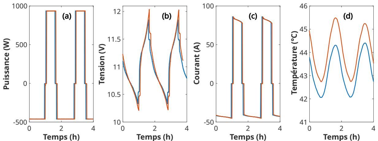
FIGURE 3.30 – Évolution du profil de cyclage entre le début (courbe bleue) et la fin (courbe orange) de la campagne de vieillissement à 40 °C.
