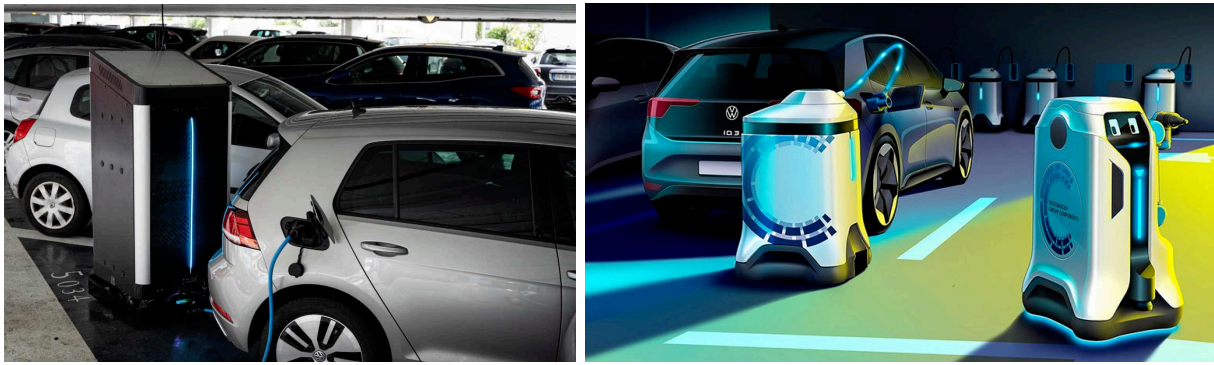
FIGURE 1.18 – Stations de recharge mobiles produites par Mob-Energy à gauche et Volkswagen à droite [Mob-Energy 2021, Volkswagen 2020].
