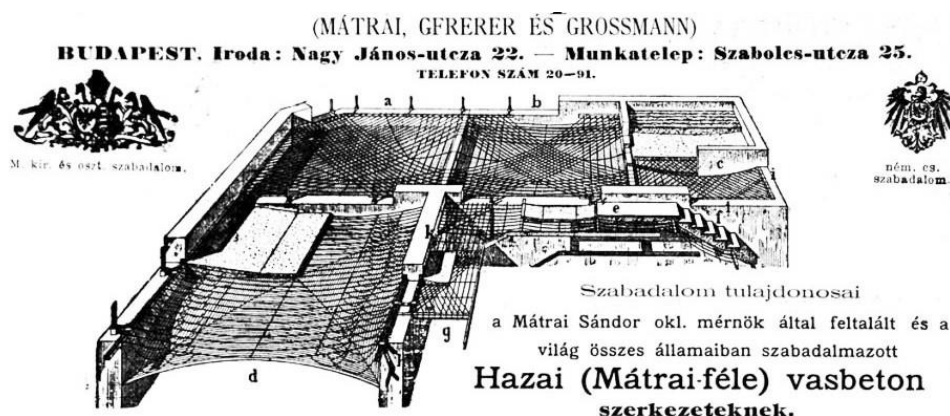
42 Système Mátrai. Principe d'armature. Publicité hongroise, autour de 1900.
