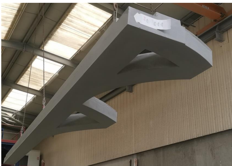
211 Élément préfabriqué en BFUP du nouveau remplage. Il faut remarquer l'épaisseur supérieure à celle d'origine. Photo : 1090 architectes.
