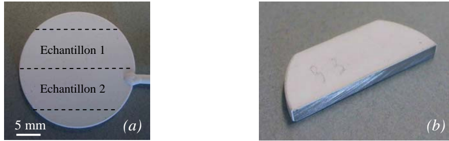
Figure II- 4: (a) Schéma de découpe des échantillons dia 25 mm (b) Echantillon obtenu
