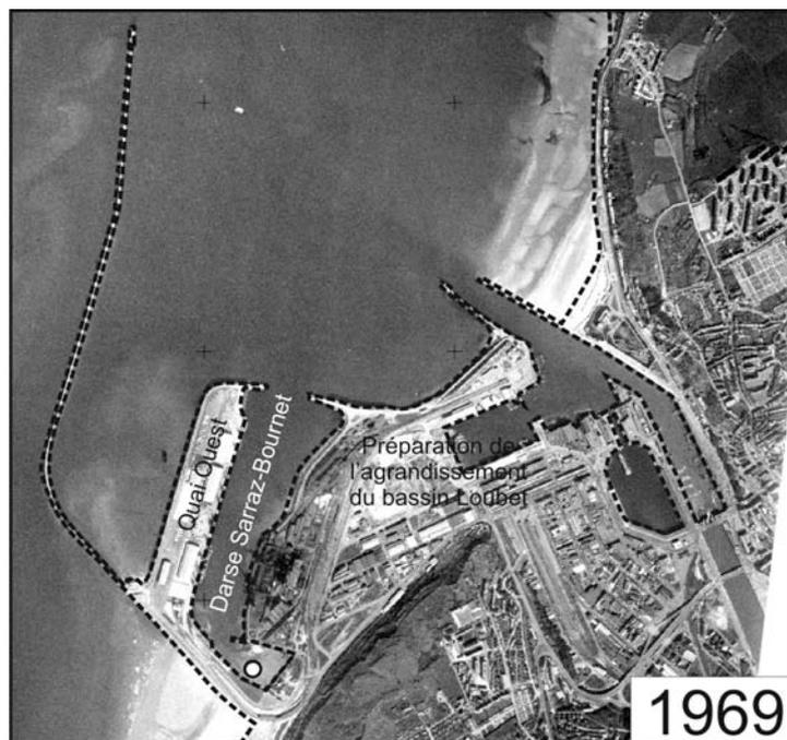
Figure 60 : Interprétation des images aériennes du Port de Boulogne en 1969 (Fond © IGN 1969 « Remonter le temps »). La construction du quai Ouest permet la structuration de la darse Sarraz-Bournet.
