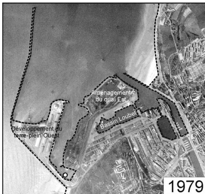
Figure 61 : Interprétation des images aériennes du Port de Boulogne en 1979 (Fond © IGN 1979 « Remonter le temps »). Entre 1970 et 1979, aménagements des terre-pleins Ouest et quai Est.
