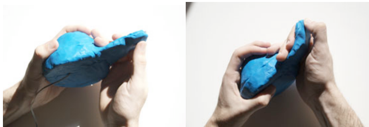
Figure 232 : Prototype physique de l'outil de démarrage/arrêt de la présentation avec une modalité de liaison captant la flexion.
