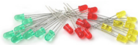
Figure 196 : Exemples d'effecteurs numériques : des diodes électroluminescentes. Illustration extraite de http://www.phidgets.com/ .
