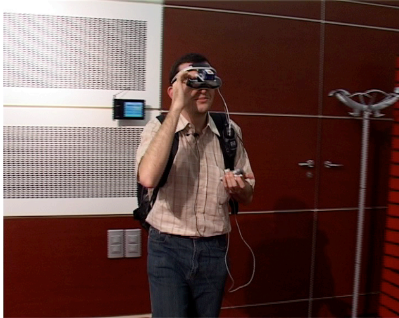
Figure 91 : Un joueur de RAZZLE porte l'équipement nécessaire (des lunettes semi-transparentes avec un capteur d'orientation monté dessus, un touchpad, ici dans sa main, et un ordinateur portable dans le sac à dos).
