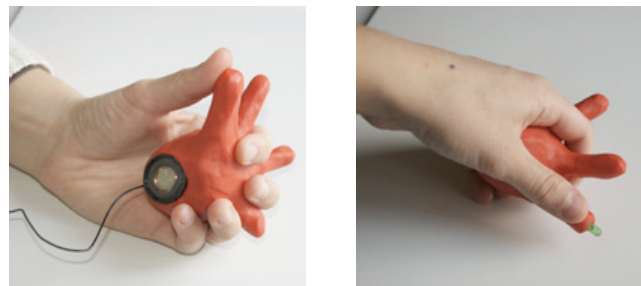
Figure 240: Alternatives de conception : sortie sonore avec un haut-parleur (à gauche), lumineuse avec une LED (à droite).
