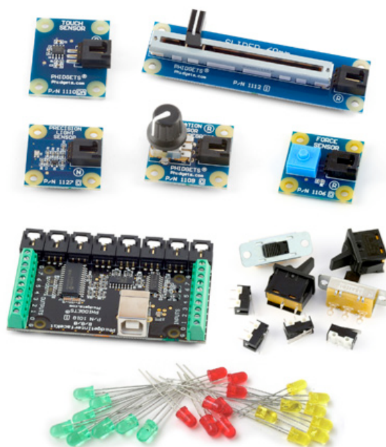
Figure 155 : Exemple de kit de Phidgets pour débuter : (de haut en bas et de gauche à droite) un capteur de toucher, une glissière, un capteur de lumière, un potentiomètre, un capteur de force, l'interface USB sur laquelle brancher les capteurs et effecteurs, 8 interrupteurs, et des LEDs.
