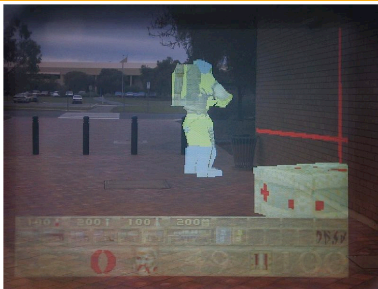
Figure 294 : Une vue dans le casque semi-transparent d'un joueur de l'ARQuake [Thomas et al., 2000] : on y voit à la fois le monde physique et les éléments ajoutés par l'ordinateur.
