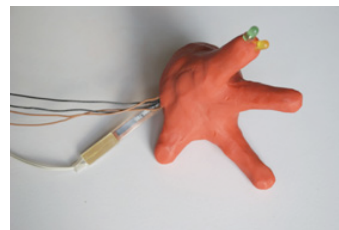
Figure 244: Prototype physique complet de l'outil dans Roam (correspondant au code OP de la Figure 238) : dans la main de l'utilisateur (gauche) et en gros plan (droite), avec capteur de flexion et diodes électroluminescentes, une verte et une jaune.
