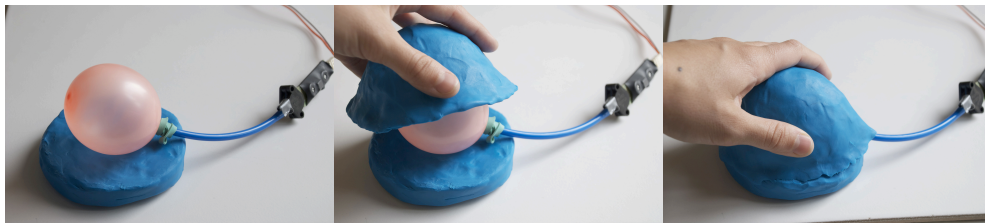
Figure 233 : Prototype physique de l'outil de démarrage/arrêt de la présentation avec une modalité de liaison captant la pression.
