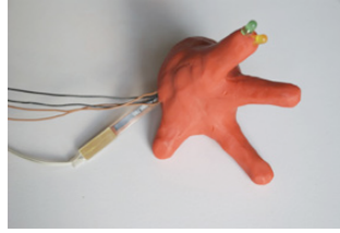
Figure 131 : Le prototype final de l'outil mixte dans Roam, avec capteur de flexion et diodes électroluminescentes vertes et jaunes.
