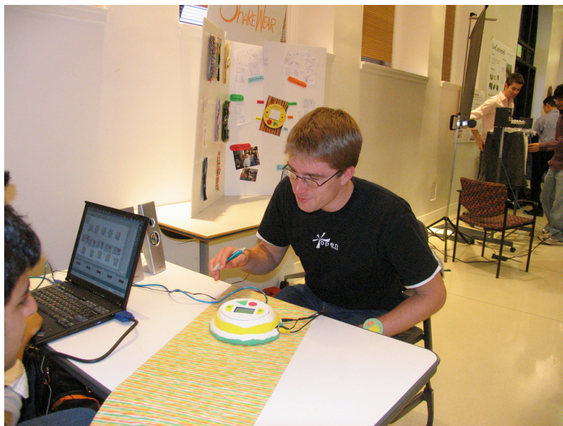
Figure 171 : d.tools pendant son utilisation. L'éditeur graphique est affiché sur l'écran de l'ordinateur, et le prototype sur la table est branché à l'ordinateur.
