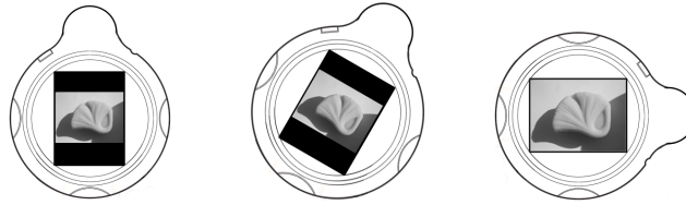
Figure 119 : Quelle que soit l'orientation de l'objet dans le plan vertical, la photo affichée est toujours dans le bon sens.
