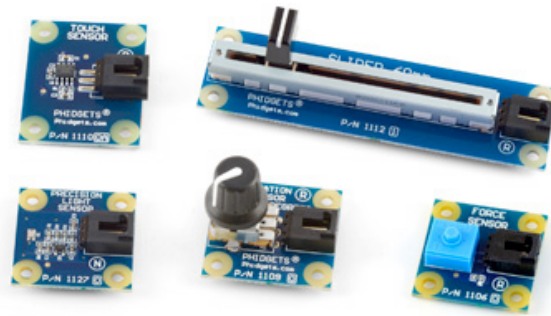
Figure 194 : Exemples de capteurs analogiques des Phidgets : (de haut en bas et de gauche à droite) un capteur de toucher, une glissière, un capteur de luminosité, un capteur de force. Illustration extraite de http://www.phidgets.com/ .
