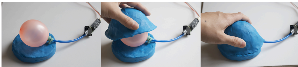
Figure 227: Prototypage de l'outil avec une modalité de liaison captant la pression.
