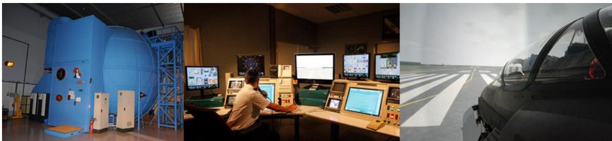
Photo 2. Simulateur de Mirage 2000D. Photo de gauche : la « boule » vue de l'extérieur. Photo du centre : pupitre de gestion du vol et des pannes qui seront implémentées au cours du vol simulé. Photo de droite : vue de l'intérieur de la « boule ». Un vrai cockpit de Mirage 2000D est à l'intérieur, monté sur vérins hydrauliques afin de maximiser le réalisme. La scène de vol est projetée sur un écran sphérique au sein duquel est situé le cockpit, ce qui favorise l'immersion (jusqu'à créer des illusions sensorielles).
