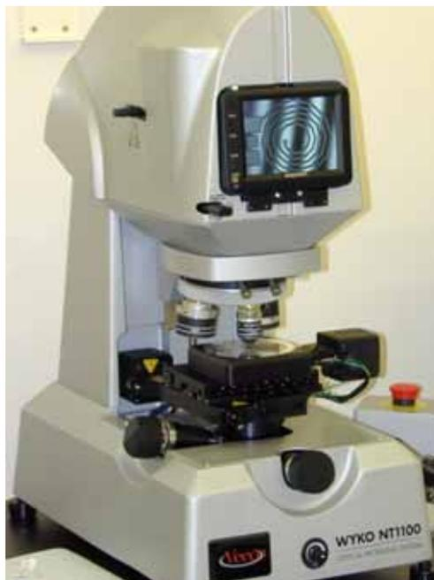
Figure 94 – Profilomètre Optique Veeco Wyko NT1100
