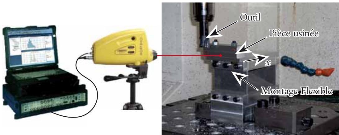
Figure 83 – Montage expérimental
