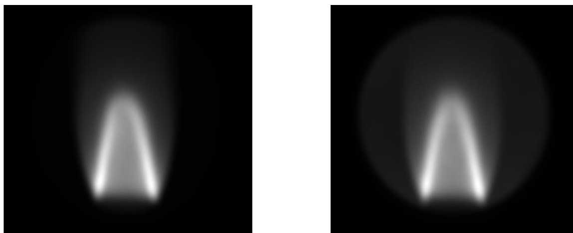
Figure 4-45 Image moyenne de flamme aluminium/air avec 20.9% d'oxygène obtenue avec le filtre 700 nm.
