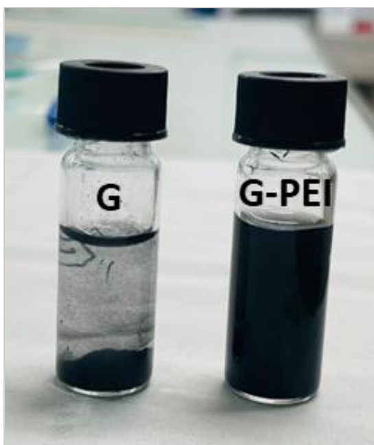
Figure 78 : images de la suspension dans l'eau du graphène (G) et G(25%)-PEI après 1h d'agitation et 1h de repos
