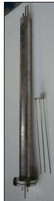
Figure 5-10 : Photographie du tube en inconel 600 et du support du résidu carboné
