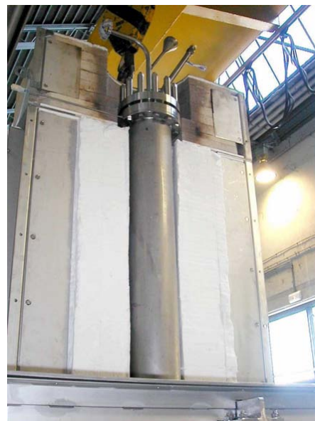
Figure 2-7 : Photographie du RTGP et de son calorifugeage
