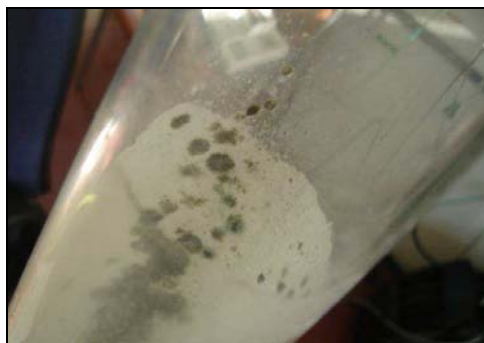
Figure 5-8 : Photographie du tube en quartz après plusieurs utilisations
