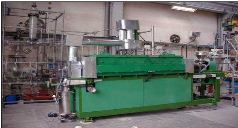
Figure 2-2 : Photographie du four tournant de pyrolyse avant l'ajout du second étage du RTGP
