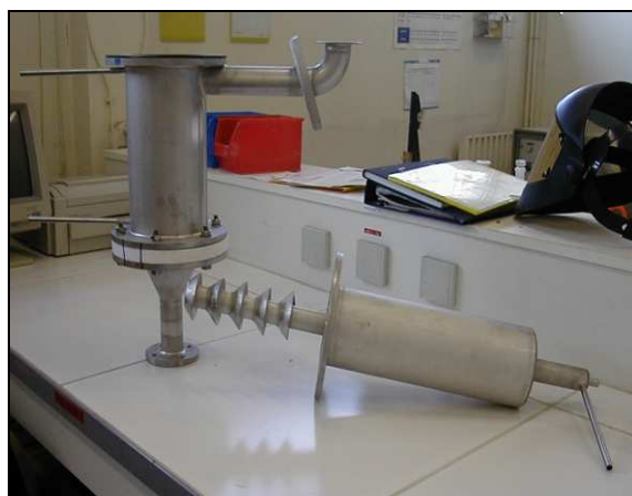
Figure 2-11 : Photographie d'un dévésiculateur
