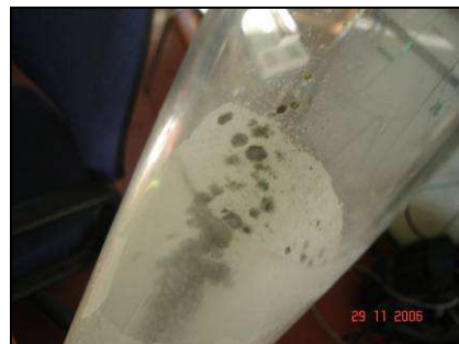
Figure 6-6 : Tube de quartz après quelques essais
