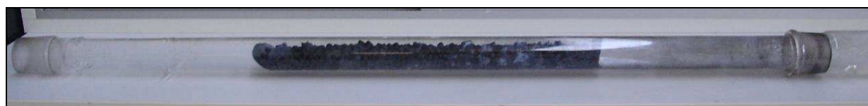
Figure 5-6 : Photographie du tube en quartz contenant du résidu carboné
