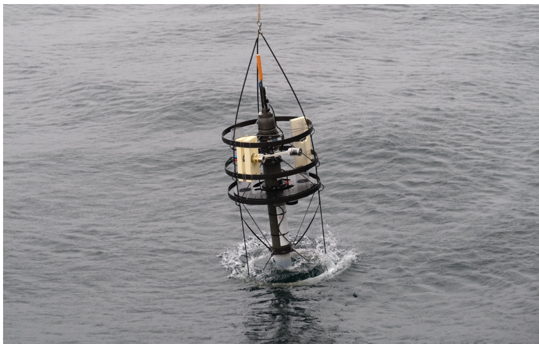
Figure 4.12 Twilight Zone Explorer. Ce flotteur est un NBST modifié pour embarquer une caméra UVP6 (au centre du flotteur) permettant de capturer des séquences de chute de particules en sédimentation.
