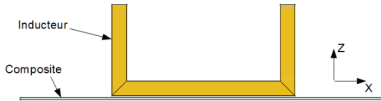
FIGURE 4.2.2 : Plaque de composite avec l'inducteur
