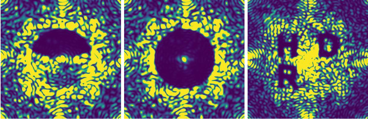
FIGURE 1.11 – Trois Dark-Holes obtenus expérimentalement sur le banc THD2, avec un coronographe de type 4 quadrant. **Gauche** : demi Dark-Hole obtenu en utilisant un seul miroir déformable ; **Centre** : un Dark-Hole symétrique obtenu avec 2 miroirs déformables ; **Droite** : un Dark-Hole un peu spécial, pour montrer notre capacité à contrôler le champ électrique dans le plan focal.
