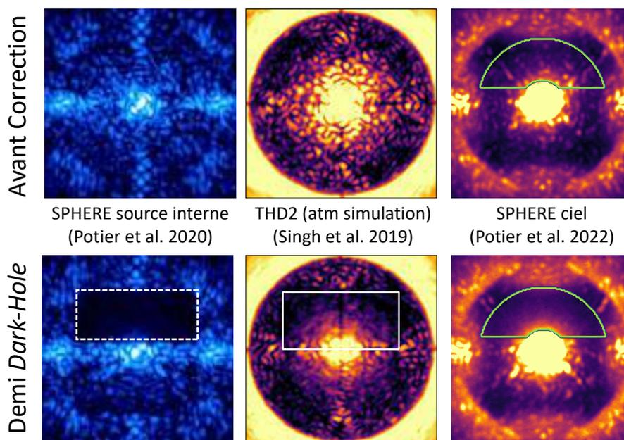
FIGURE 1.20 – Trois Dark-Holes obtenus par l'équipe très haute dynamique du LESIA. **Gauche** : un Dark-Hole obtenu sur source interne sur l'instrument SPHERE POTIER et al. (2020a) . **Centre** : un Dark-Hole obtenu sur le banc THD avec un disque de phase reproduisant les aberrations que verrait un coronographe derrière une optique adaptative extrême SINGH et al. (2019). **Droite** : un Dark-Hole obtenu sur SPHERE sur le ciel POTIER et al. (2022a).
