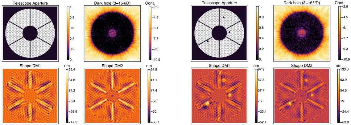
FIGURE 1.10 – Correction avec ACAD-OSM de la pupille de l’ELT. Chaque figure montre en haut à gauche la pupille complexe que l’on cherche à corriger, en bas les surfaces de miroirs déformables obtenues avec ACAD-OSM, et en haut à droite le Dark-Hole obtenu. **À gauche**, la pupille sans segments manquants / inopérables. **À droite**, la pupille avec trois segments manquants / inopérables. Figure adaptée de MAZOYER et al. (2018a).
