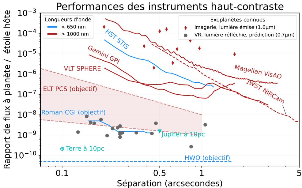
FIGURE 1.21 – Limites de détection ( $5\sigma$ ) des instruments terrestres et spatiaux. Les diamants rouges représentent quelques-unes des exoplanètes actuellement imagées, avec leur rapport de flux planète-étoile connu dans la bande H. Les ronds gris représentent les exoplanètes connues détectées par la méthode des vitesses radiales (VR), pour lesquelles le rapport de flux de lumière réfléchie est prédit dans le visible. Adapté et traduit de BAILEY et al., 2018.
