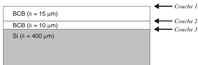
Figure 3.10. Les différentes couches de la technologie multicouches BCB-Si.
