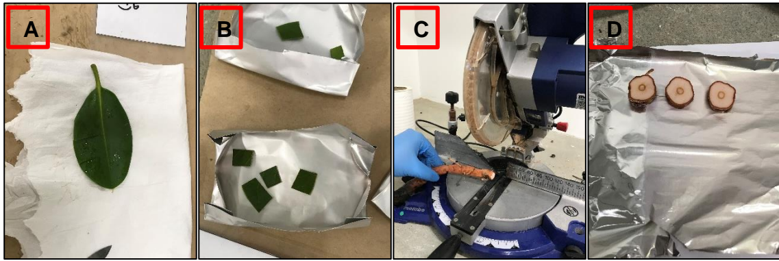
Figure 4-2. Photos de traitement des échantillons de végétaux au laboratoire avec (A) feuille de R. stylosa fraîche, (B) sections de la feuille A pour analyse MEB, (C) découpe d'une racine de R. stylosa avec scie circulaire et (D) sections de pneumatophores d' A. marina pour analyse MEB.
