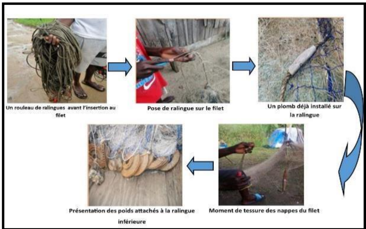
Planche photographique 18 : Quelques séquences de gréement du filet calé de fond (Cédric Ondo Obame, Bac-aviation, 2020)
