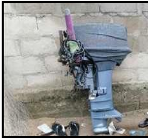
Photographie 3 : Un moteur hors-bord de 45 chevaux de marque Yamaha (Cédric Ondo Obame, Bac-aviation, 2020)
