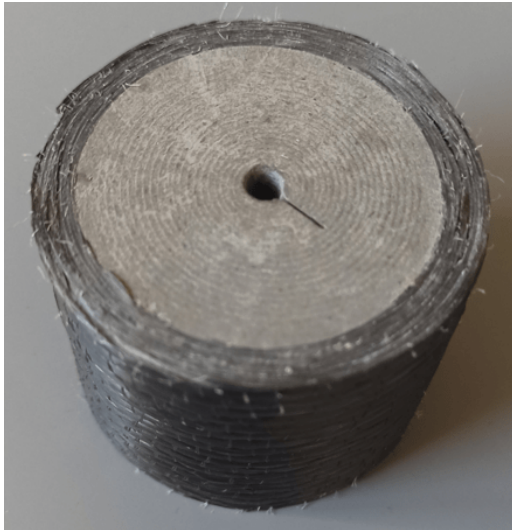
(a) Échantillon en cours d'entaille
