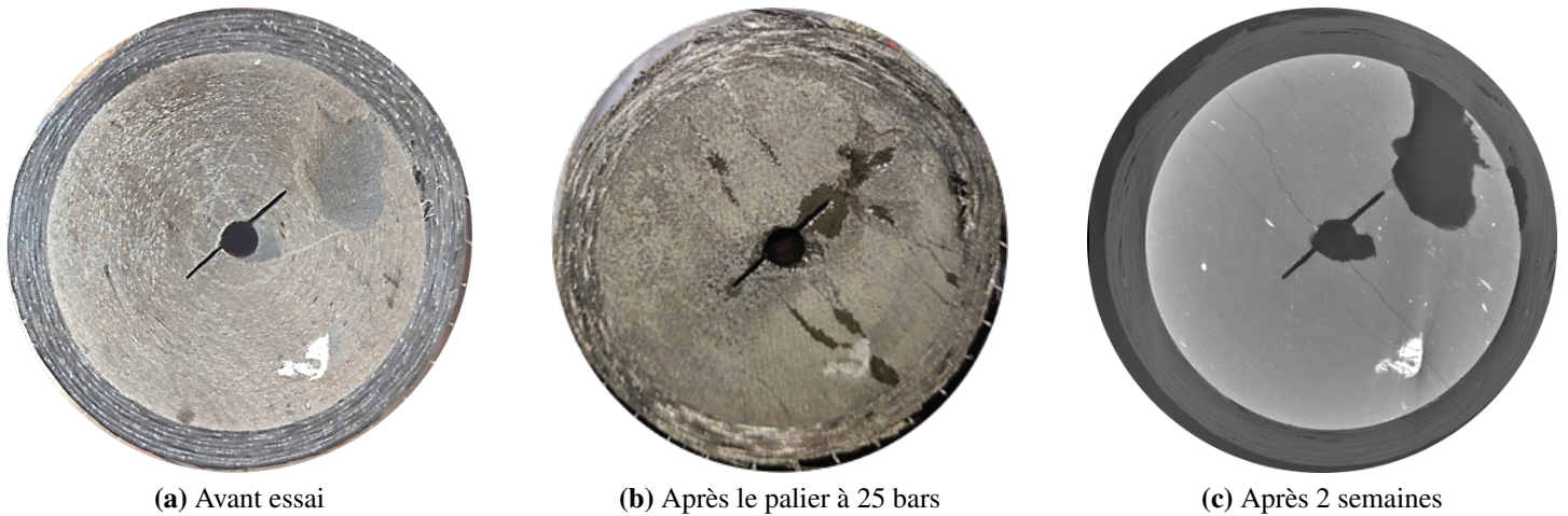
FIGURE 3.17 – Photographies et coupe tomographique de l'échantillon T55-4
