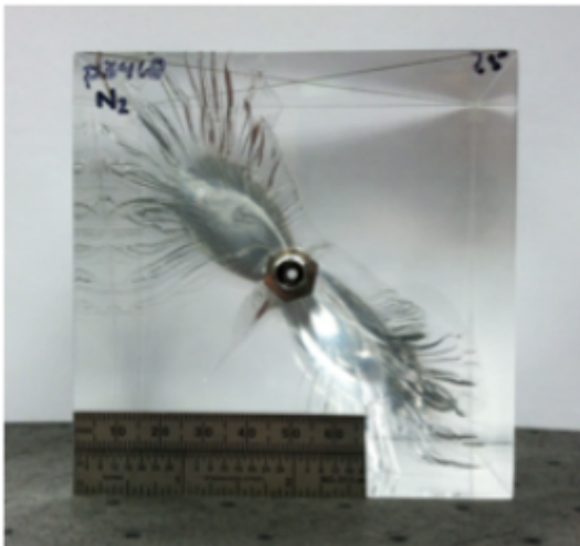
FIGURE 1.20 – Exemples de résultats de fracturation sur cubes de PMMA, extrait de [5]
