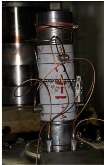
FIGURE 1.19 – Exemple de montage pour les émissions acoustiques, extrait de [50]
