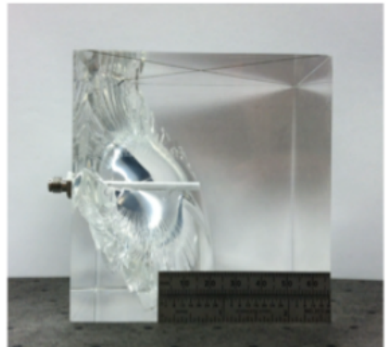
FIGURE 1.20 – Exemples de résultats de fracturation sur cubes de PMMA, extrait de [5]
