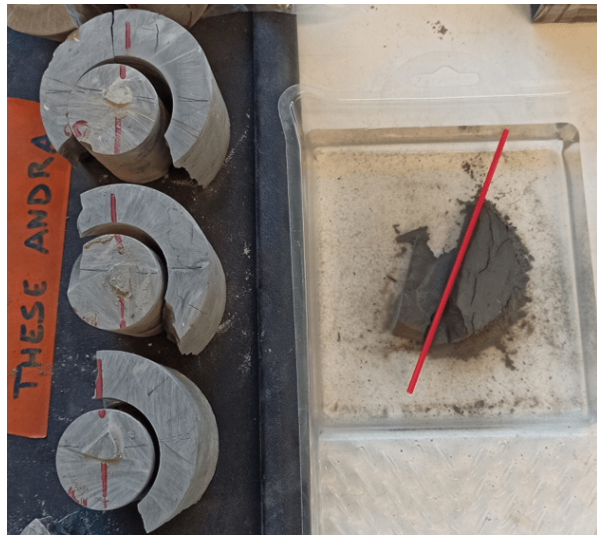
(b) Repérage du litage par immersion d'un tronçon
