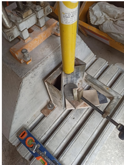
(a) Montage pour le carottage
