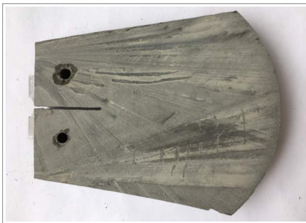
(a) Échantillon TDCB issu d'un tronçon de cellule T1
