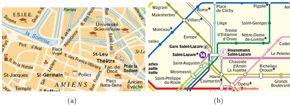
FIGURE 5.1 – Illustration de la différence entre les approches métriques et topologiques. (a) Exemple métrique : une portion du plan de la ville d'Amiens, (b) exemple topologique : une portion du plan du métro de Paris.
