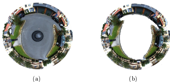
FIGURE 4.1 – Définition de la portion de l'image utilisée dans le processus de construction de signature visuelle. (a) Image omnidirectionnelle acquise. (b) Portion de l'image qui sert au calcul des signatures.
