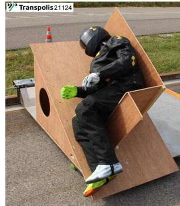
FIGURE 8.4 – Mannequin de choc positionné sur le chariot de lancement
