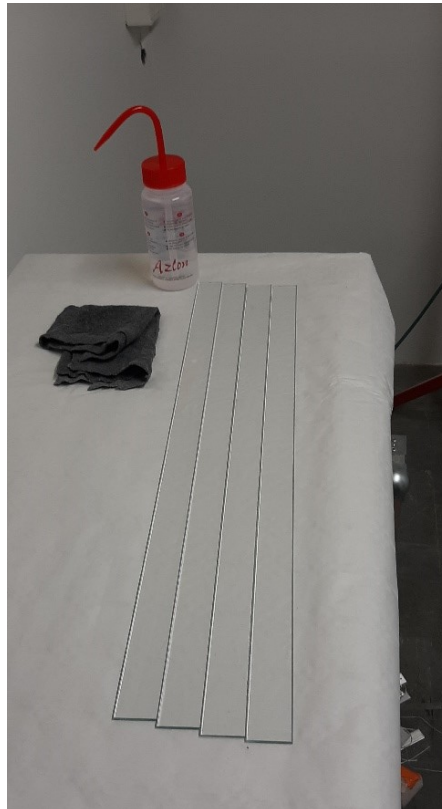
FIGURE 4.2 – Peaux en verre et acétone utilisé pour le traitement de leur surface. Cela permettait de contrôler la qualité de la surface des peaux qui seront en contact avec le cœur.
