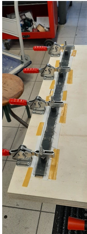
FIGURE 4.5 – Pose finale d'un échantillon verre-époxy-verre. La pression appliquée est exercée par 4 sauterelles de bridage, le téflon permettant de gérer l'épaisseur du matériau est fixé à l'aide de bandes adhésives.
