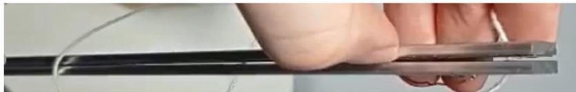
FIGURE 4.7 – **Échantillon (D)** en aluminium. Les peaux en aluminium étaient très fortement découplées mécaniquement. Fabrication février 2022.
