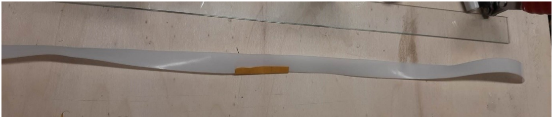
FIGURE 4.4 – Bande de téflon (PTFE) non-adhérent à la colle époxyde.
