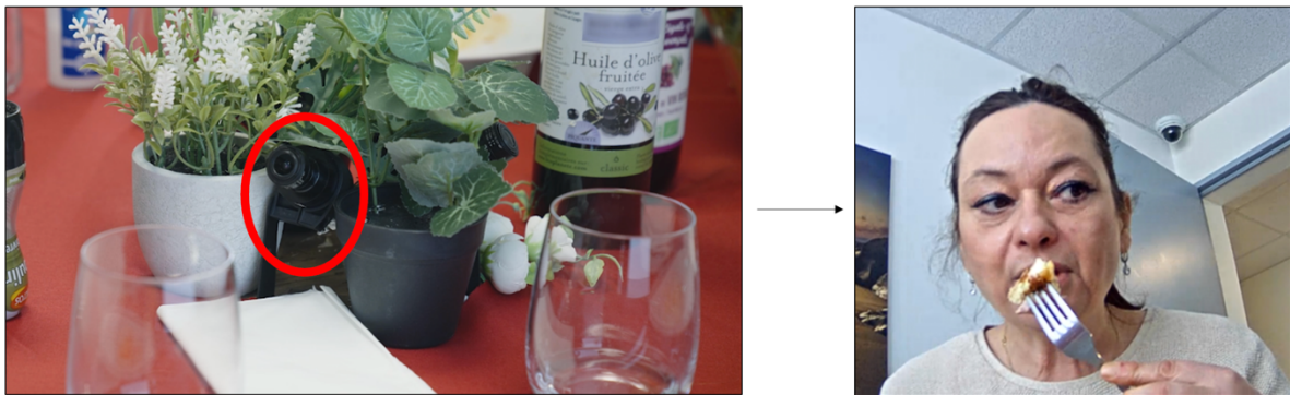
Figure 16 : Caméras frontales au centre de table et vue de ces caméras
