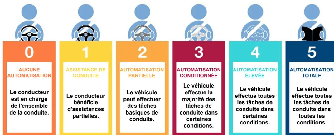
FIGURE 1.1 – Les différents niveaux d'autonomie définis par la SAE. <sup>1</sup>
