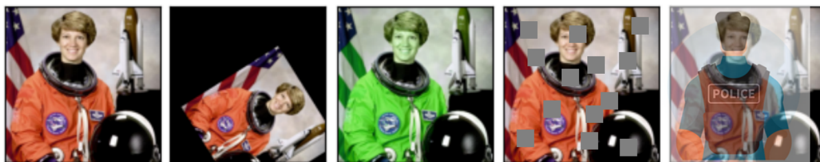
FIGURE 2.11 – Illustration de transformations pour l’enrichissement de données, avec de gauche à droite : l’image d’origine, rotation, inversion des canaux de couleur, suppression de patches , combinaison linéaire de deux images. 7
