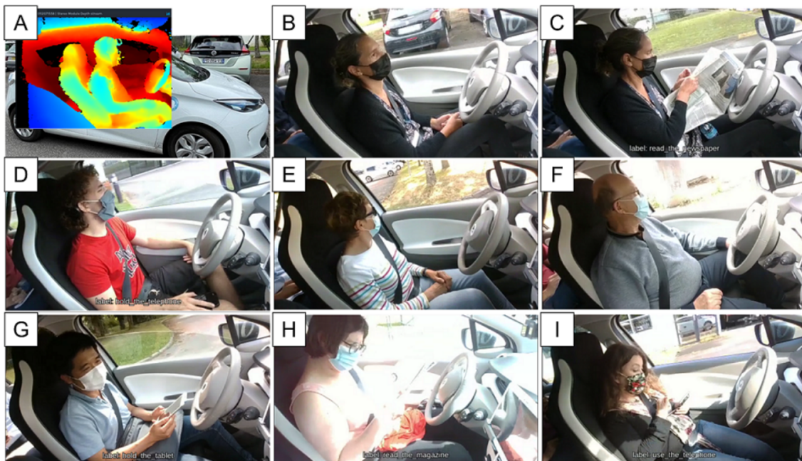
FIGURE A.2 – Exemples d'enregistrements lors de l'expérimentation à Nantes pour le projet AutoBehave avec : l'image de profondeur à l'intérieur de la voiture autonome (A), une participante durant la phase libre (B) et scénarisée (C), et différents exemples d'illuminations, de participants et d'activités (D-I) (Crispim-Junior et al., 2023).
