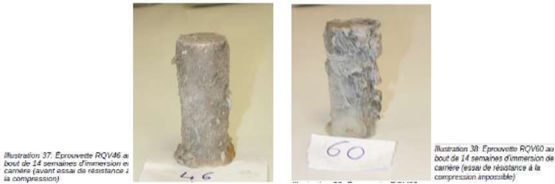
Figure 56 Évolution des éprouvettes soumises à la dissolution dans la carrière de Roquevaire. (Bertolus et al., 2017)
