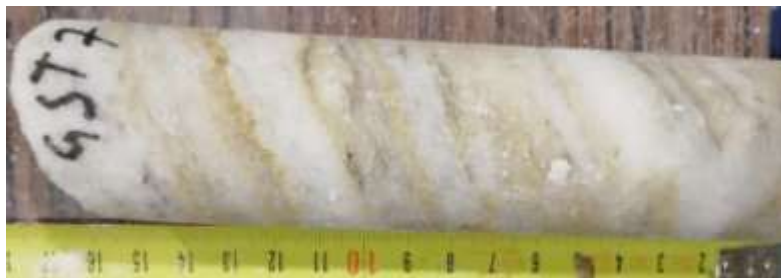
Figure 75 Carotte réalisée dans le gypse saccharoïde à interlits
