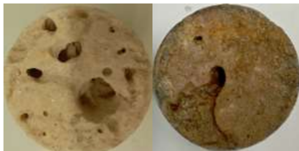
Figure 140 Photographie de chemins préférentiels développées dans des gypses saccharoïdes après altérations par percolation pendant 2 mois. À gauche le faciès pur, à droite le faciès à interlits
