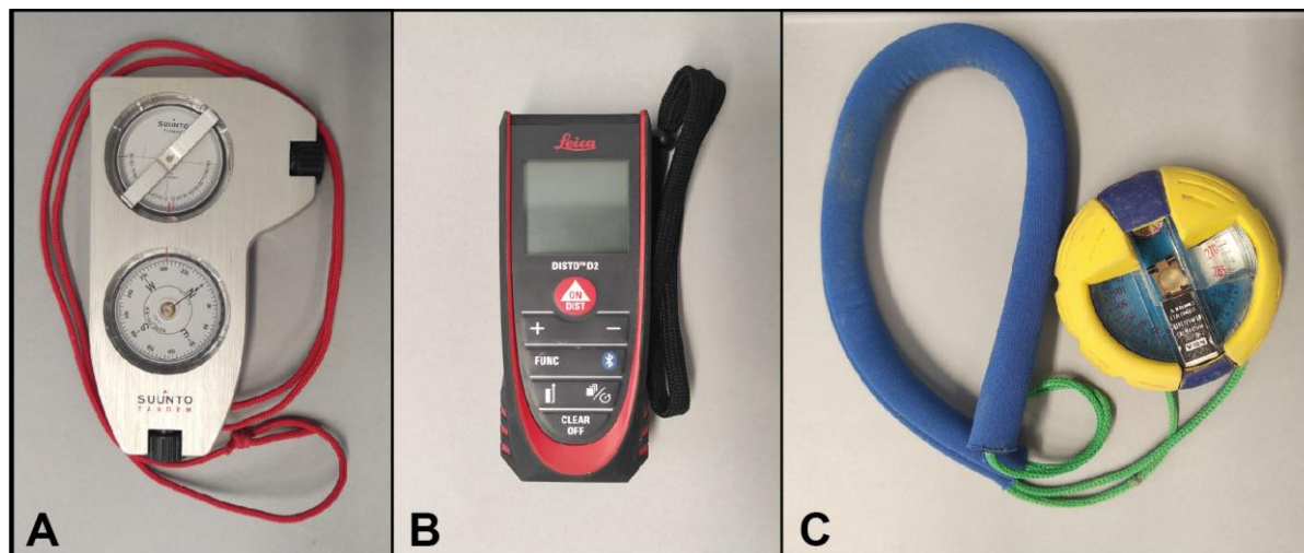
Fig. 2.17 : Matériel de topographie souterraine. A. Clinomètre ; B. Lasermetre ; C. Boussole.
