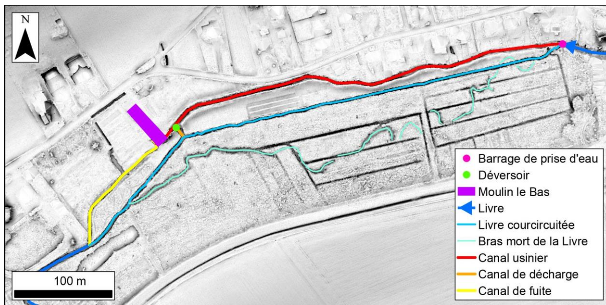
Fig. 3.60 : Ouvrage hydraulique au fil de l'eau dit "Moulin le Bas" à Fontaine-sur-Ay. Le barrage et le déversoir sont présentés en vignette C et D, Fig. 3.58.
