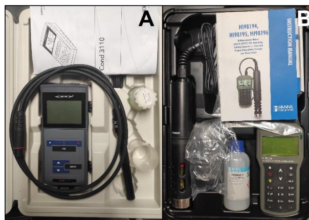
Fig. 2.19 : Sondes utilisées dans les campagnes de mesures. A. Conductimètre ; B. Sonde multi-paramètres.
