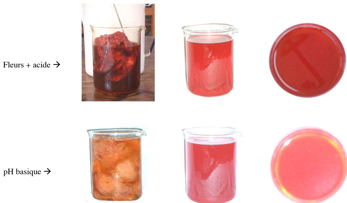
Fig. 26 – Processus de fabrication du kuchibeni (rouge à lèvres au carthame) - Recette n°4
