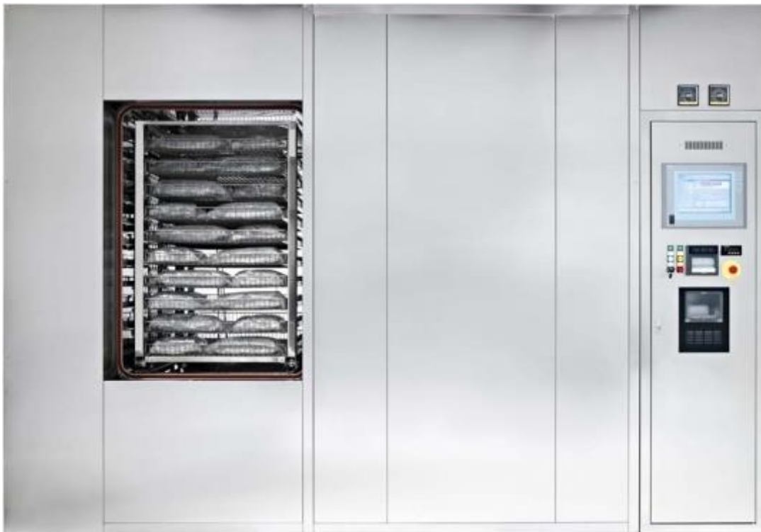
Figure 14 : Autoclave industriel permettant de réaliser des cycles de stérilisation par la chaleur humide [100] .
