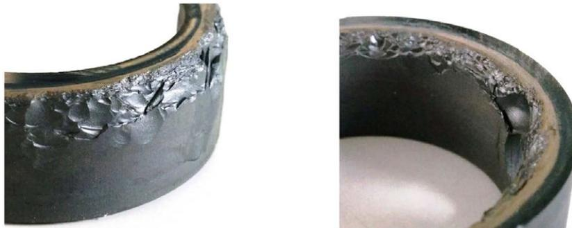
FIGURE 4.33 : Anneaux de carbure de silicium endommagé après un essai tribologique.
