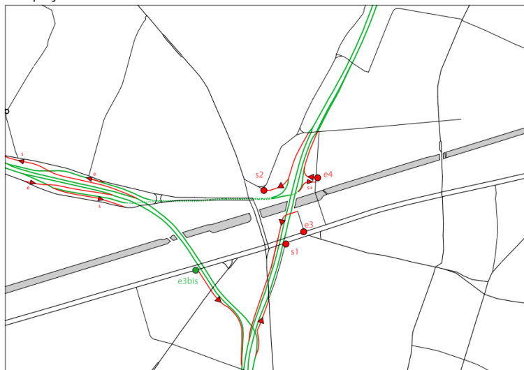
19. Pont de Bondy, schémas comparatifs des principes divergeant de l'état actuel et convergeant projeté, Etude Pont de Bondy, 2011
