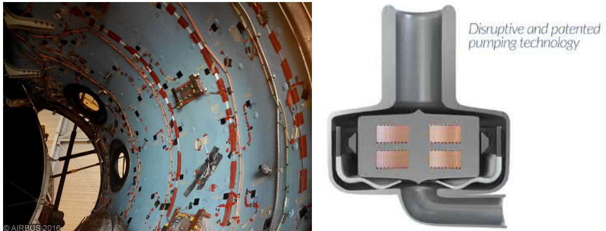
FIGURE B.4 – A gauche, la partie interne fixe d’une nacelle d’A380 instrumentée avec des éléments piézo-électriques dédiés au contrôle de la santé des structures. A droite, une vue éclatée de la pompe à membrane ondulante produite par la société CORWAVE.
