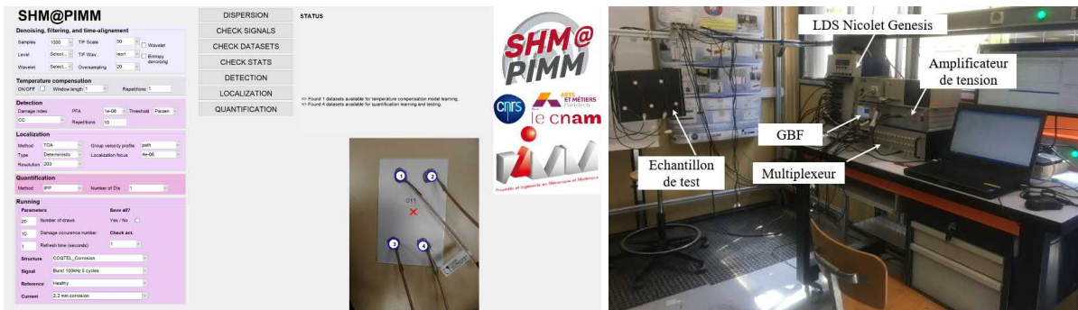
FIGURE A.3 – À gauche, l’interface graphique de la boîte à outils Matlab SHM@PIMM. À droite, la plate-forme expérimentale associée.
