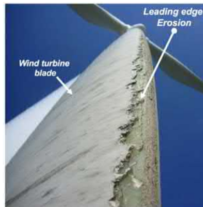
(d) Eolienne endommagée (d'après [R|Nay95])
