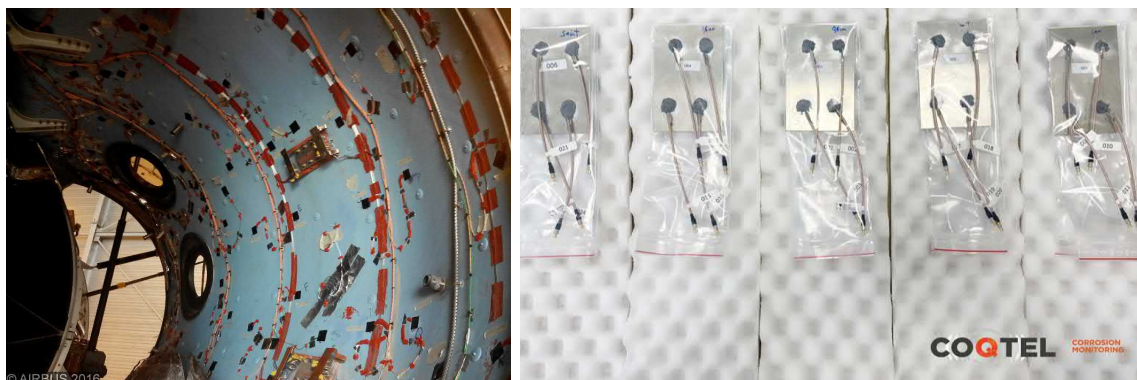
FIGURE I.3 – Exemples de structures vibrantes intelligentes multi-fonctionnelles capables de contrôler leur état de santé. A gauche, une pièce d'un Airbus A380 équipée d'éléments piézo-électriques (projet CORALIE avec SAFRAN) et à droite des coupons en aluminium issus du projet ANR COQTEL et également équipés d'éléments piézo-électriques.
