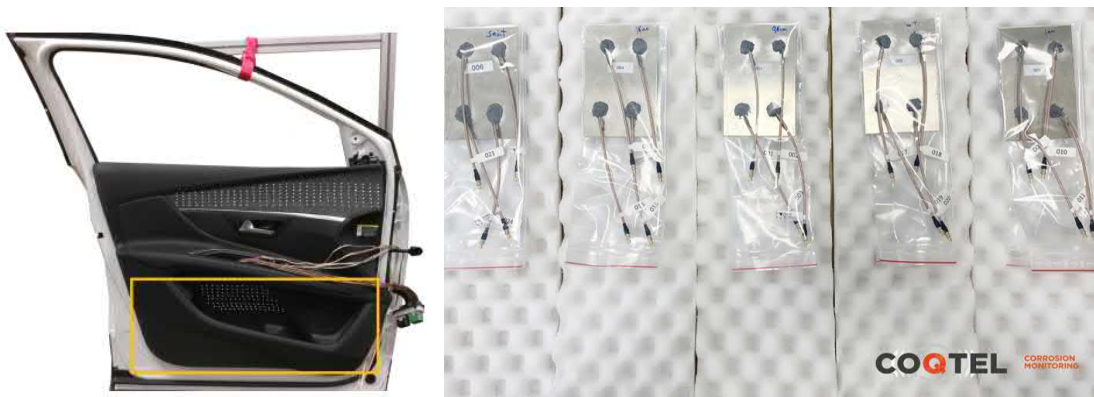
FIGURE B.3 – A gauche, la portière avant d'une 3008 qui a servi de démonstrateur dans le cadre du projet ANR SOURCE. A droite, les échantillons d'aluminium avec des trous calibrés qui ont été utilisés dans le cadre du projet ANR COQTEL.
