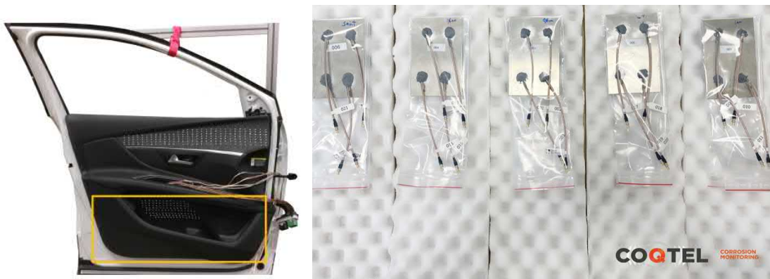
FIGURE B.3 – A gauche, la portière avant d'une 308 qui a servi de démonstrateur dans le cadre du projet ANR SOURCE. A droite, les échantillons d'aluminium avec des trous calibrés qui ont été utilisés dans le cadre du projet ANR COQTEL.
