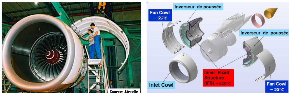
FIGURE I.9 – Images d'une nacelle d'Airbus A380 (d'après [E|Fen15]). À gauche, la nacelle au cours d'une inspection avec la capote de soufflante (FC) ouverte. À droite une vue éclatée de la nacelle où les deux structures d'intérêt, la capote de soufflante (FC) et la structure fixe interne (IFS), sont visibles.
