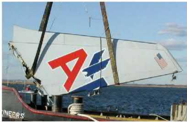
(a) Empennage vertical du vol 587 (d'après [R|Fox+05]).
