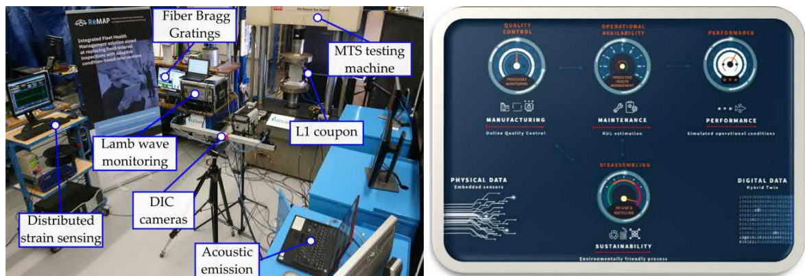
FIGURE B.2 – A gauche, une photographie des moyens d’essais mis en œuvre dans le cadre du projet REMAP. A droite, un schéma explicitant l’idée directrice du projet MORPHO.
