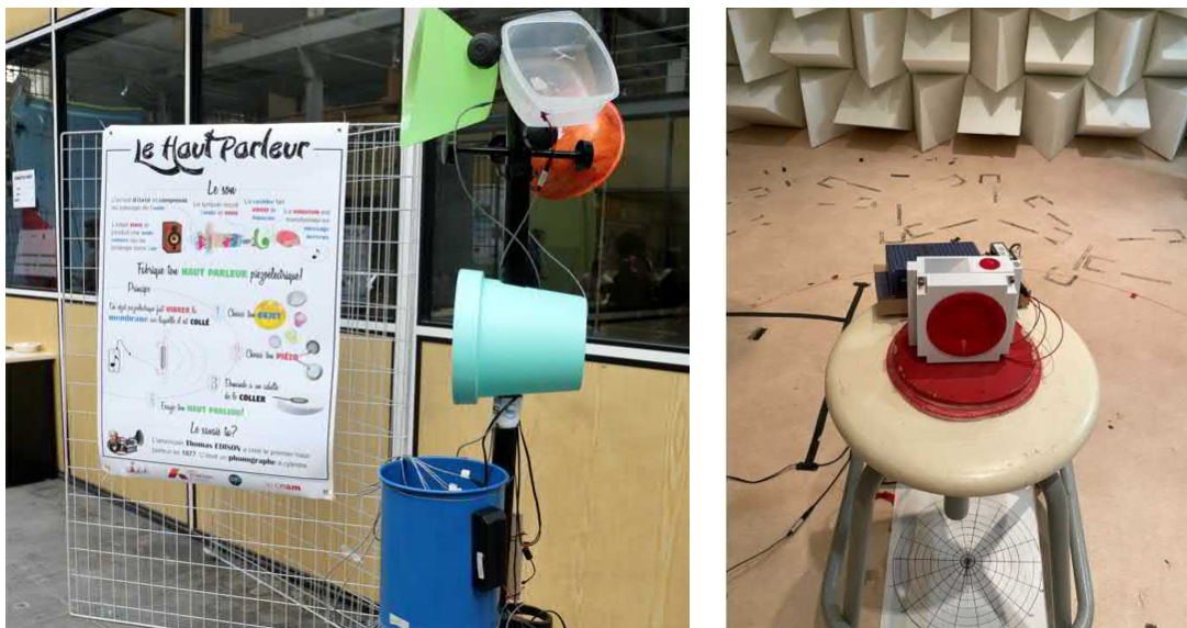
FIGURE A.2 – À gauche, “Arbre à haut-parleurs” et poster présentés lors de l’atelier “Buzz le piézo!”. À droite, exemple de haut-parleur piézo-électrique réalisé par impression 3D dans le cadre du cas d’étude “Smart Structures”.
