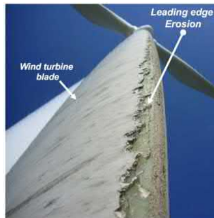
(d) Eolienne endommagée (d'après [R|Nay95])
