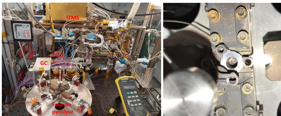
Figure 24 : Couplage Pyrolyse-GC-ITMS (Engineering Test Unit) au NASA-GSFC et gros plan du four de pyrolyse
