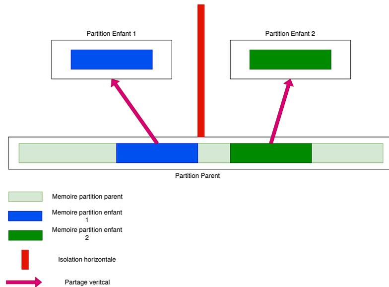
FIGURE 4.9 – Illustration des propriétés de sécurité de Pip
