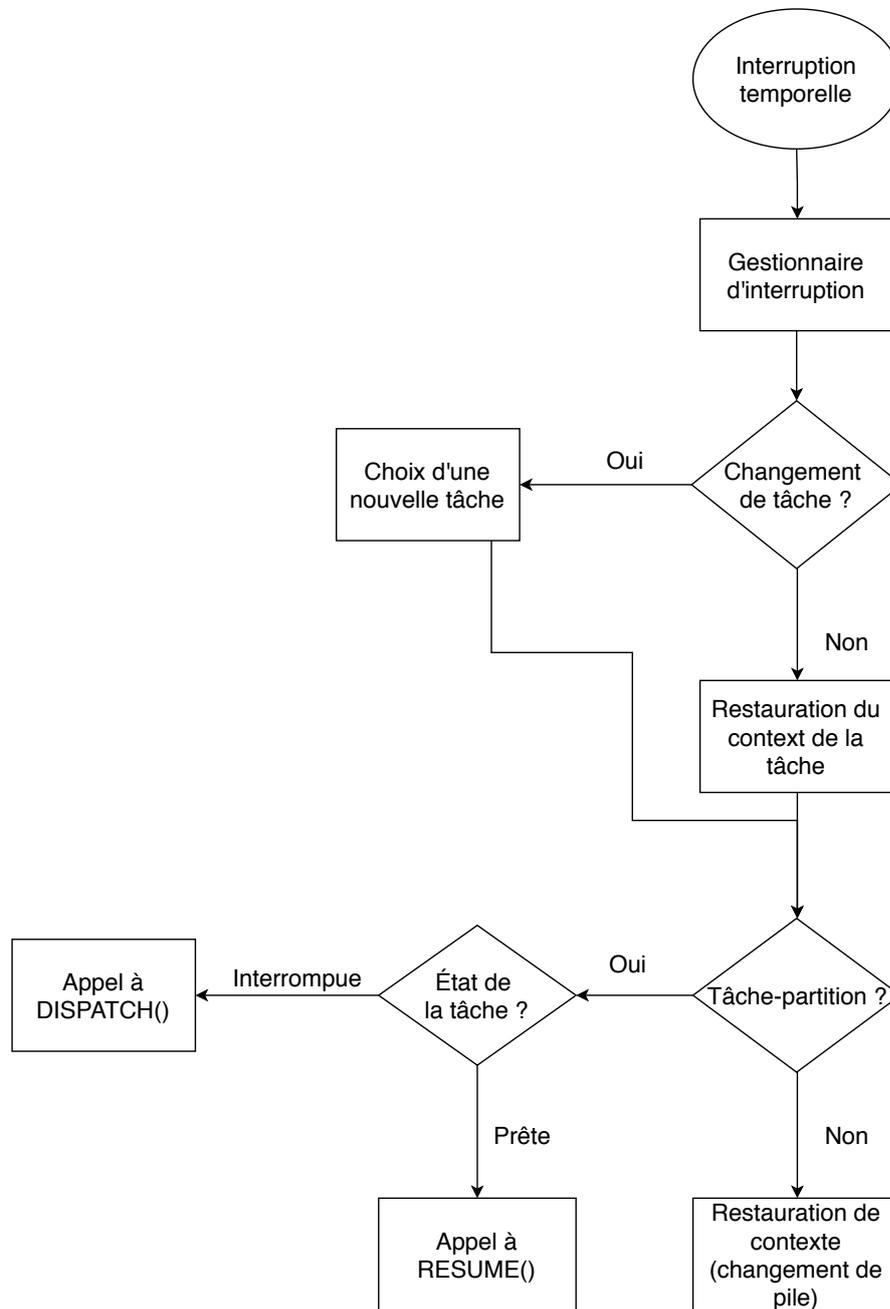
FIGURE 4.13 – Mécanisme d'ordonnancement des tâches et des tâches-partitions
