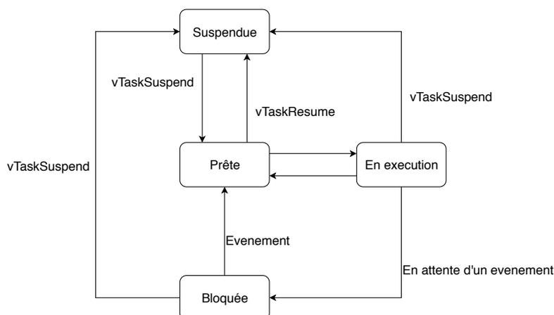
FIGURE 4.11 – État de fonctionnement des tâches
