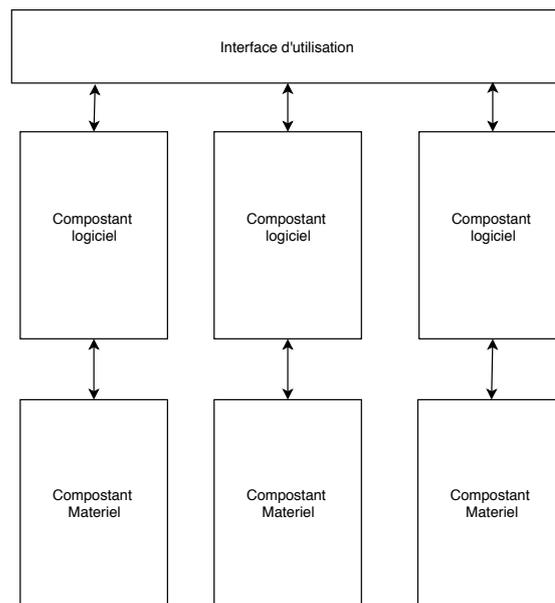
FIGURE 2.1 – Architecture primaire d'un système embarqué
