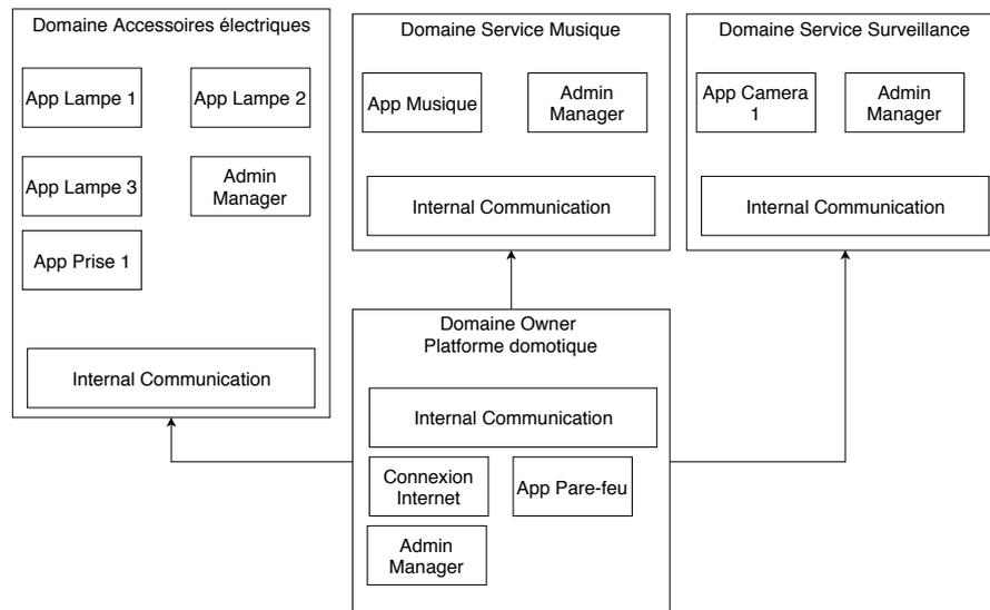
FIGURE 4.19 – Illustration de la décomposition logiciel de la plate-forme domotique
