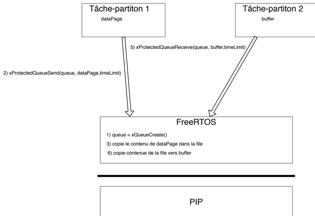
FIGURE 4.14 – Illustration des communications entre tâches-partitions
