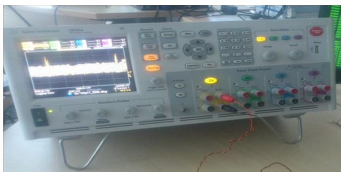
FIGURE 5.3 – Analyseur de puissance Agilent N6705A
