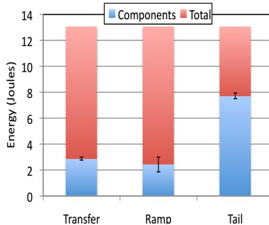
FIGURE 4.5 – Contribution du temps de queue à la consommation énergétique totale du module lors du transfert de 50 kilo-octets de données sur un module de communication 3G [BBV09].
