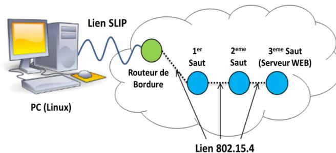
FIGURE 3.2 – Banc de test expérimental consistant en un réseau de capteurs sans fil.
