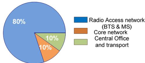
FIGURE 4.2 – Consommation énergétique d'une infrastructure d'un réseau cellulaire [Lou07].
