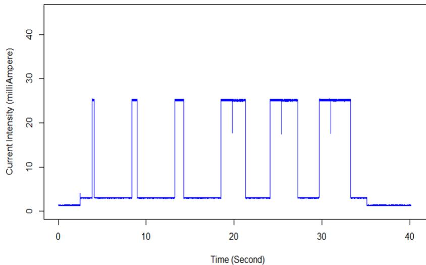
FIGURE 6.8 – Trace énergétique de transmission de trames via un module LoRa avec une faible puissance. Les trames sont de tailles : 1, 51, 101, 151, 201, 251 octets.
