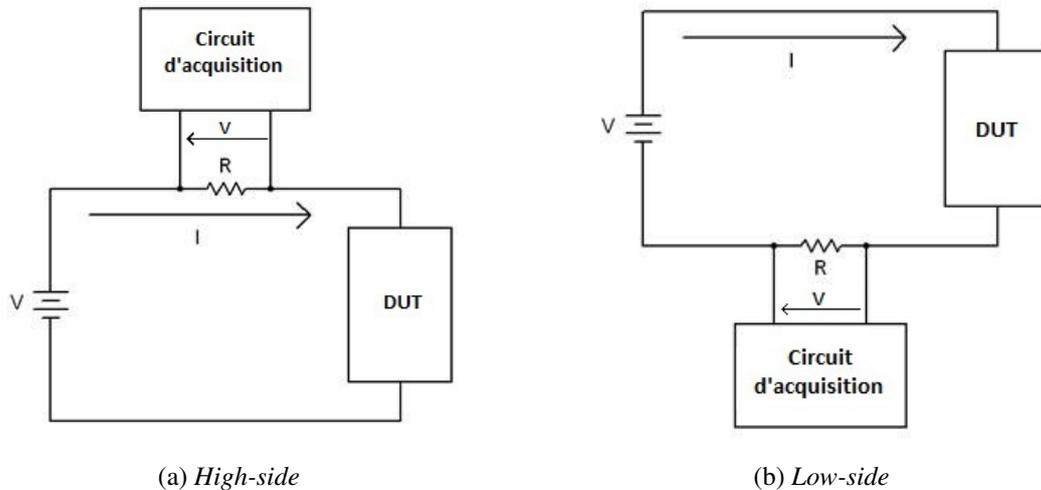
FIGURE 2.6 – Mesure via résistance de shunt
