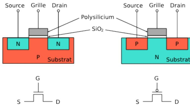
FIGURE 2.2 – Composition interne d'un transistor CMOS
