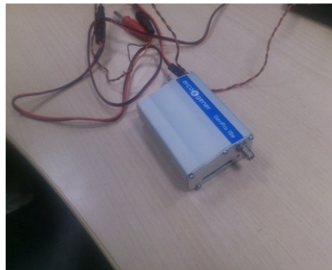
(b) Modem GPRS Genpro18e
