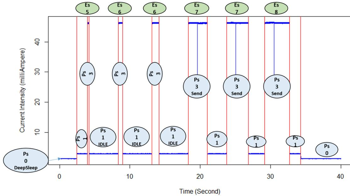
FIGURE 6.13 – Assignation et regroupement des états énergétiques et des états de puissance (configuration : puissance de transmission haute).
