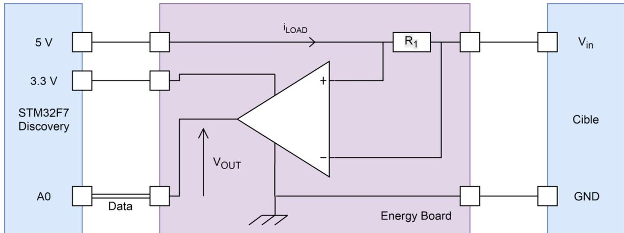
FIGURE 5.4 – Illustration du dispositif de mesure représentant le cœur de la carte fille de mesure.
