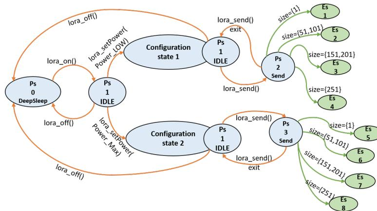
FIGURE 6.14 – Modèle énergétique obtenu sur le cas d'utilisation de transmission de trames de différentes tailles.
