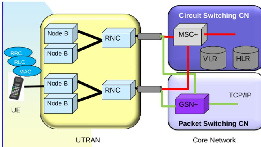
FIGURE 4.1 – Architecture d'un réseau cellulaire UMTS.
