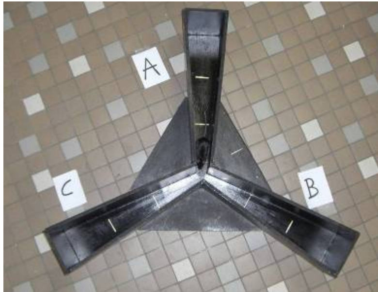
Figure III.7 : Photo du dispositif du labyrinthe en Y, vue de dessus. Le dispositif est en bois, les trois branches entourées de parois de 20 cm de haut sont resserrées au niveau où elles se rejoignent.
