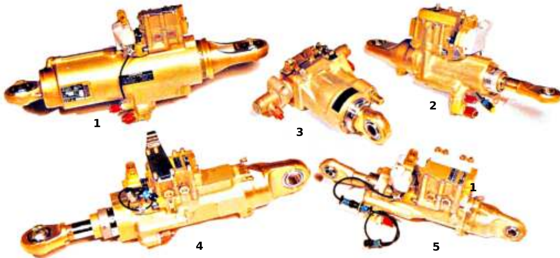
FIG. 1.4: Les servocommandes de l'Airbus A 300 (Air Equipment) (Source : [Car04]).
