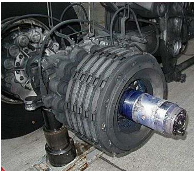
FIG. 1.11: Photo des freins d'un A340 (Crédit : Mitucci)
