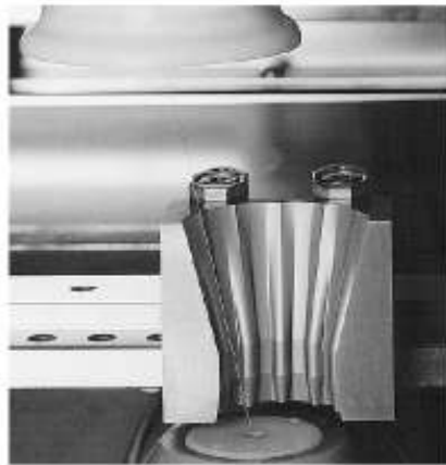
Exemple d'usinage par électroérosion
