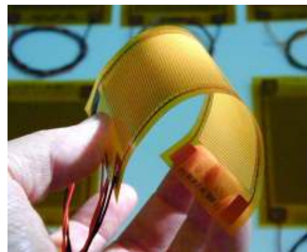
(b) Actionneur piézocomposite
