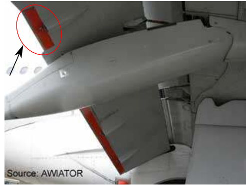
FIG. 1.8: Mini TED sur un aileron d'A340 - Test Phase II - Toulouse
